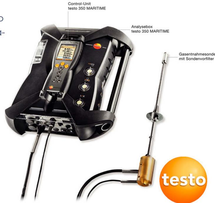
Das Abgasanalysegerät testo 350 MARITIME V2 eignet sich ferner zur Überprüfung der in MARPOL Annex VI festgelegten NOx-Grenzwerte. Die NOx-Werte werden z.B. bei behördlichen NOx-Kontrollen geprüft.
